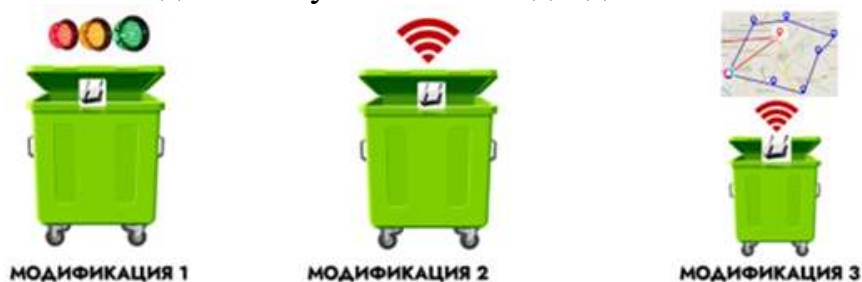
Рисунок 1. Варианты (модификации) системы для контроля заполнения контейнера
