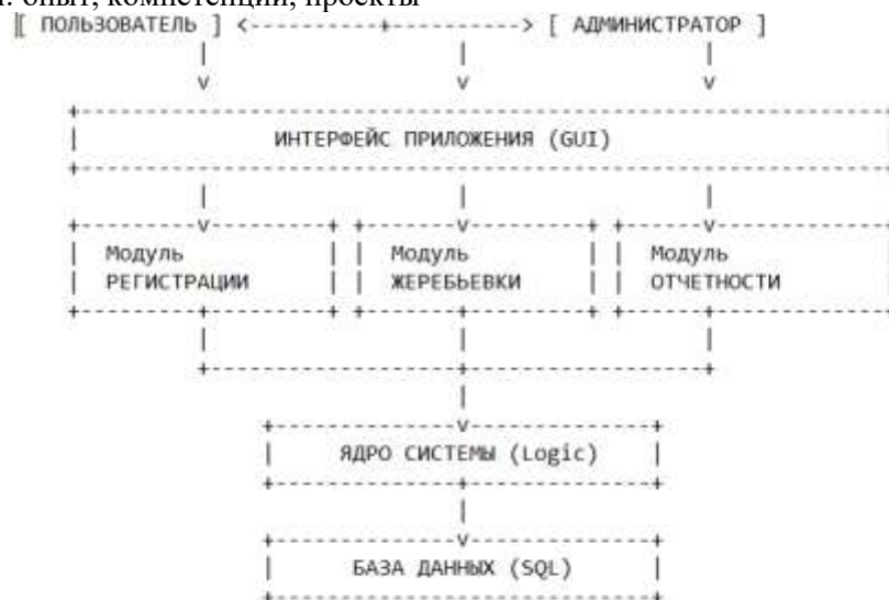
Рисунок 2. Функциональная архитектура информационной системы
