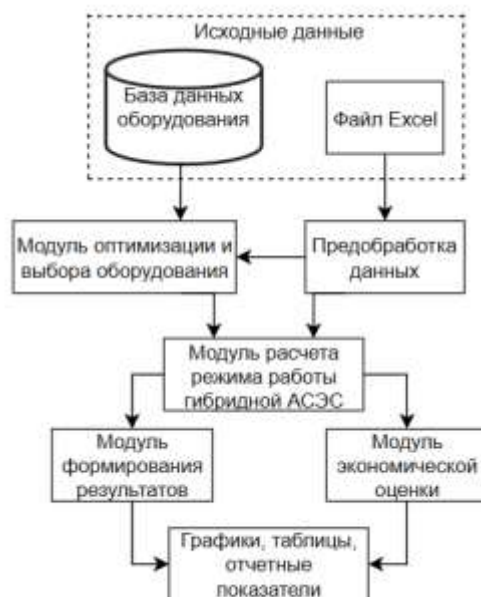
Рисунок 10. Схема программной реализации автоматического расчета режима
