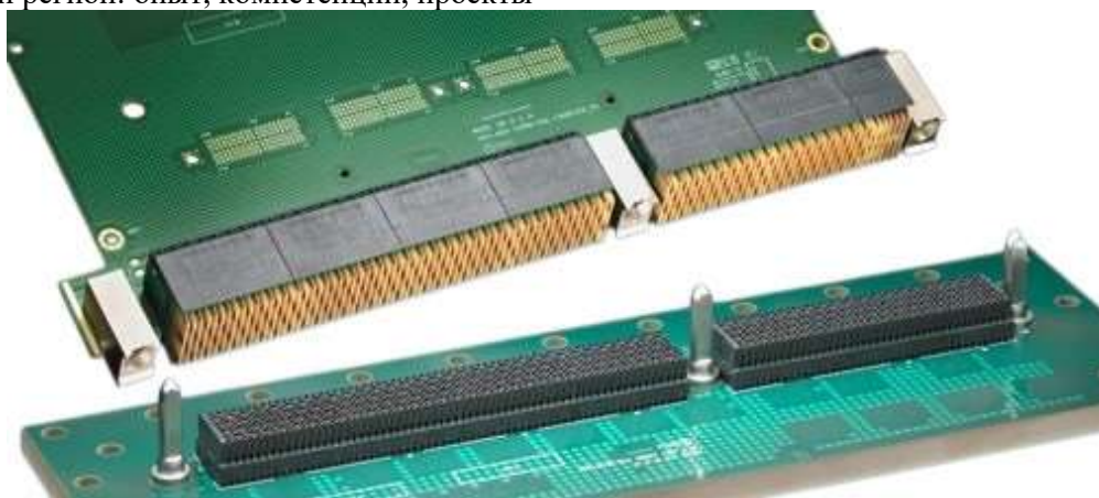
Рисунок 4 - Высокоскоростной соединитель СКП445
