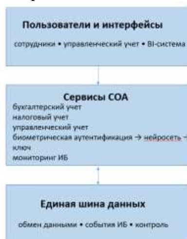
Рисунок 1. Сервис-ориентированная архитектура интеграции управленческих и защитных механизмов с единой шиной данных
