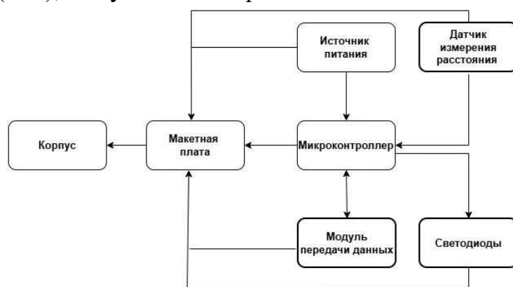
Рисунок 2 Структурная схема системы определения загруженности контейнера
