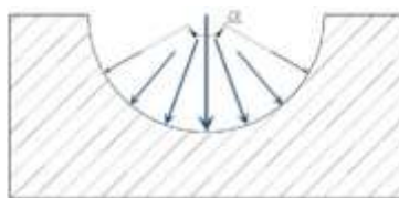
Рисунок. 1 Схема действия нагрузки – давления смятия
