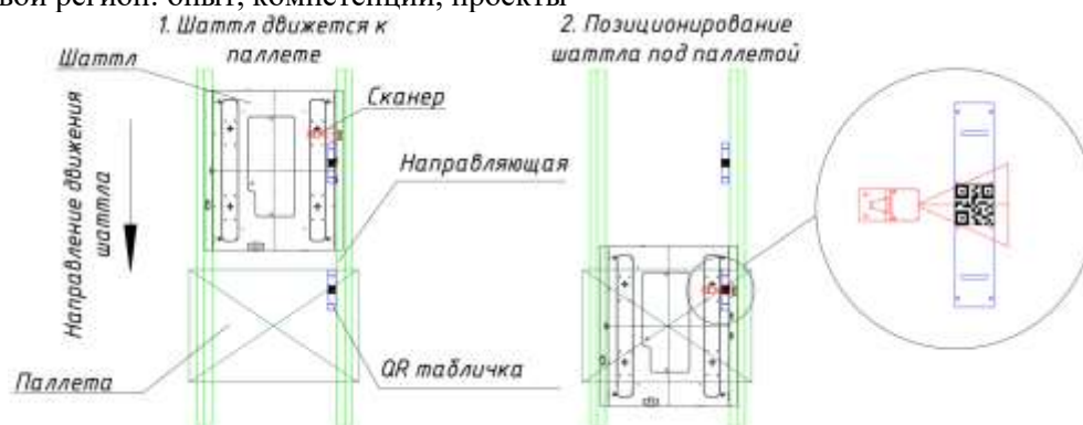
Рисунок 2. Схема позиционирования шаттла по QR-коду
